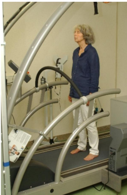
Abb. 3: Probandin bei der Standanalyse, Verlauf des Druckzentrums über die Zeit (posturales Schwanken)
